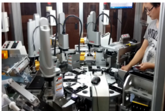
机器视觉定位系统在插件与屏幕组装方面的应用
