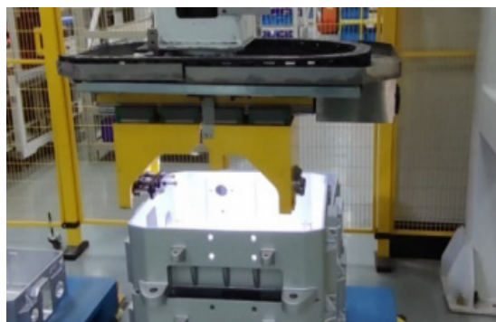
机器视觉定位在大型工件智能定位中的应用
