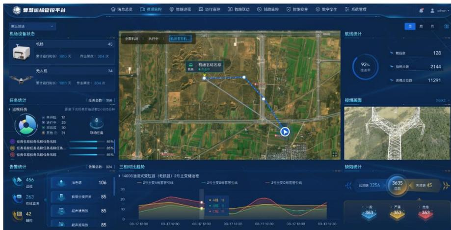
**无人机智能巡检系统：**无人机自主巡检平台支持输、变、配巡检一体化管理，包括杆塔台账管理、巡检计划与任务管理、飞行监控、航线管理、任务调度、缺陷分析、缺陷对接上报等功能，实现无人机电力巡检业务流程闭环管理。
