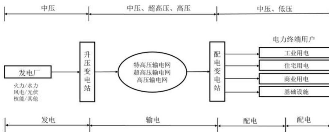
以我国电力系统为例，发电机输出的中压电能需经变电环节升至 110kV~1,000kV，方能实现大规模、低线损的远距离输电，电能输送至用电区域后需降至 110kV~10kV 分配和接入各类工业企业、公建设施等用电负荷较大的终端用户，最后再降至低压 380/220V 分配和接入低压用户。原则上，220kV 及以上电压等级为输电电压，集中应用在输电环节；110kV 连接输电与配电两大领域，处于电能由输电向配电的转换环节；10kV、20kV 和 35kV 为中压配电电压，其中 10kV 是我国应用最广的配电电压等级。
