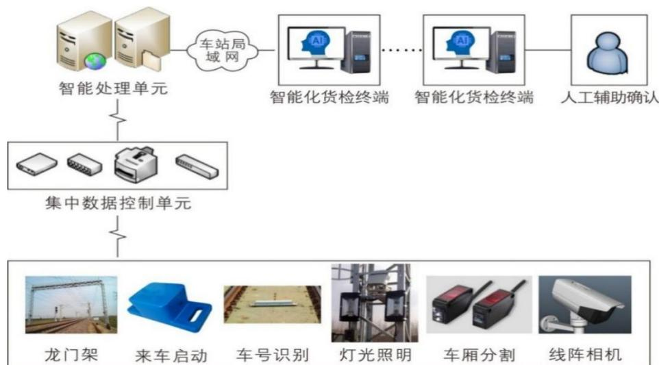
图 12：货车装载状态高清智能检测系统
