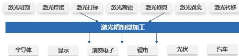
图1 激光精细微加工应用领域和加工方式
