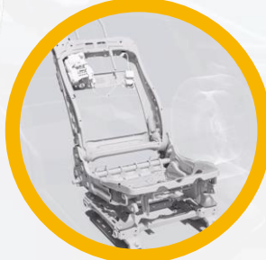
措施2：座椅集成安全带，包括EMVSR/EVSR-机械电子式车感卷收器/电子式车感卷收器，实现安全带锁止功能
