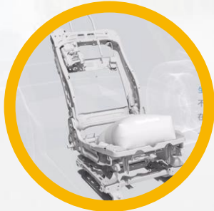
措施3：坐垫气囊，在碰撞早期能抵消腰椎力，缓解上躯干的碰撞能量
