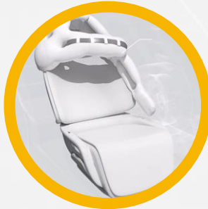
措施4：头套式安全气囊，实现正面、侧面、小偏置、翻滚等多种碰撞场景下的乘员重点部位保护
