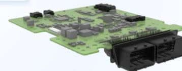
2024年，公司多合一控制器XCU产品顺利量产交付，该产品能够将整车控制、电机控制、动力管理、车身控制、智能网联等多种功能集成于一个高效的硬件平台，显著提高了系统的响应速度和可靠性。
