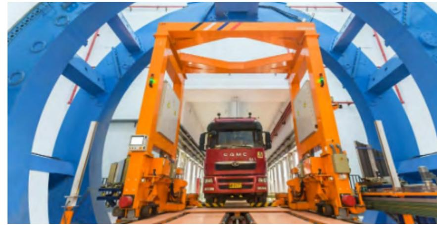
全球首套航空集装箱 CT 安检系统“CTitan”将超大超重货物安检流程简化，被列入民用航空安全检查设备使用许可清单
