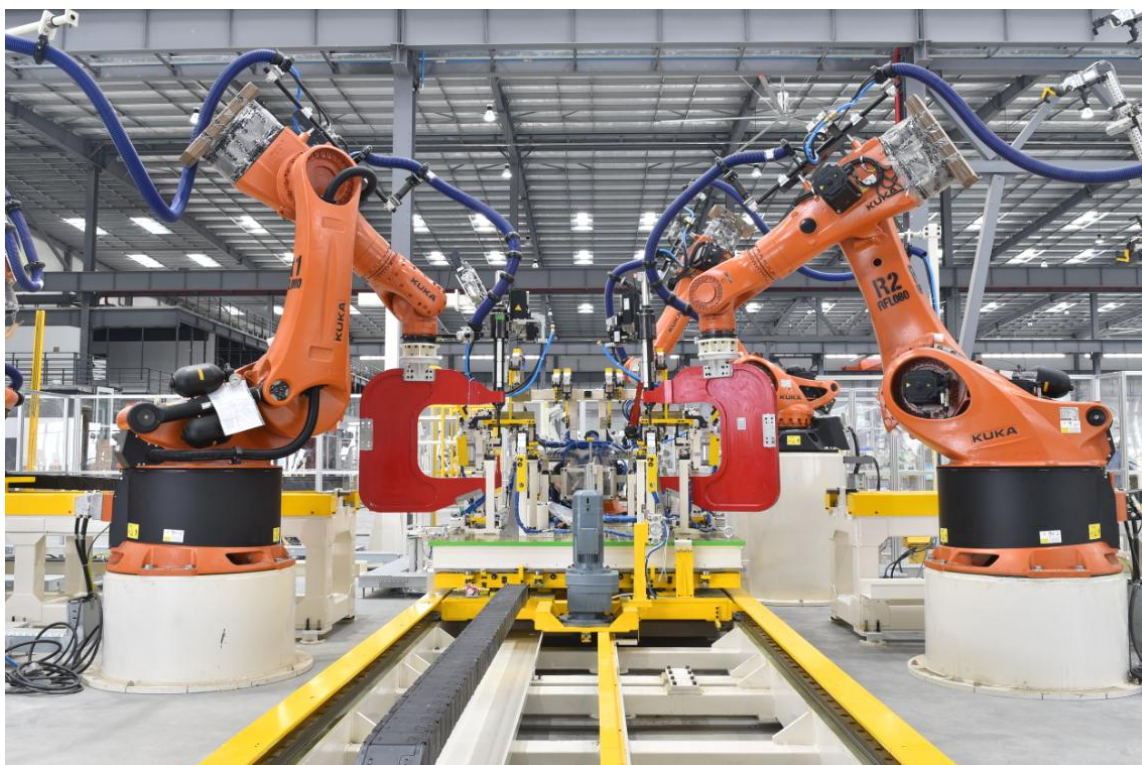
图：FDS、SPR 连接工艺应用于产线中
