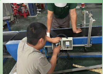
生产线加装急停开关
