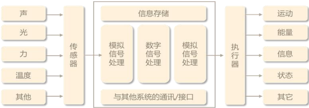
图：MEMS 工作原理 来源：前瞻产业研究院
