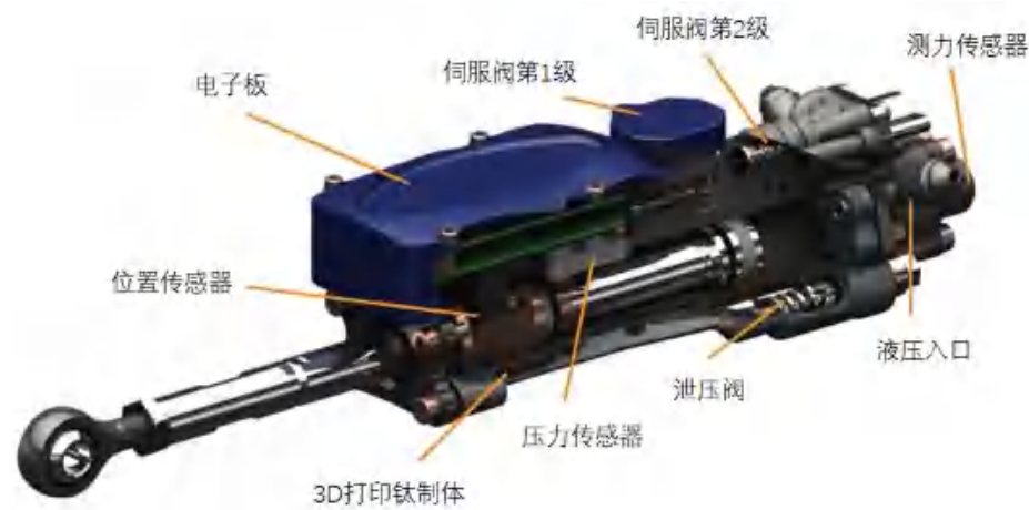
电液驱动关节结构示意图
