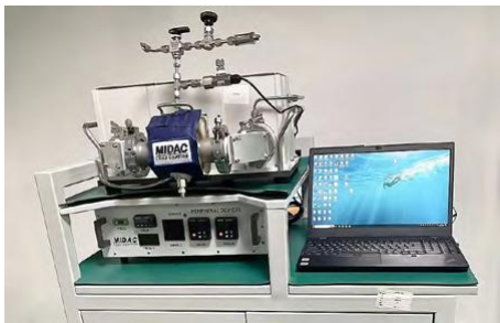
图注：Scrubber 处理效率测试平台，搭建 FTIR 处理效率测试平台，优化氮氧化物处理技术，建立系统热设计理论模型
