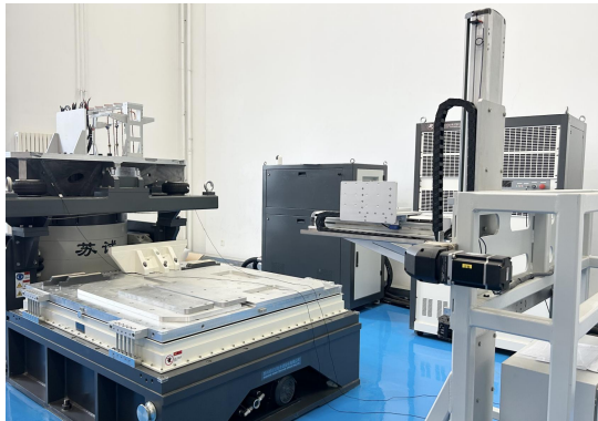
图注：振动实验室，开发振动平台测试方法，完成核心器件可靠性测试，完善结构振动响应测试方法，支持失效问题根因分析与持续改进
