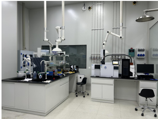
图注：物理&化学实验室，引入 ICP-MS、GC-MS 等物化检测设备，建立并完善相关检测方法，完成氟化液、冷冻机油的物理性能与化学性能测试
