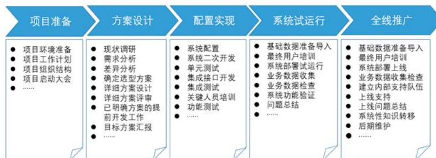
图 4-7 泰国众鑫工厂 MES 系统实施流程步骤
