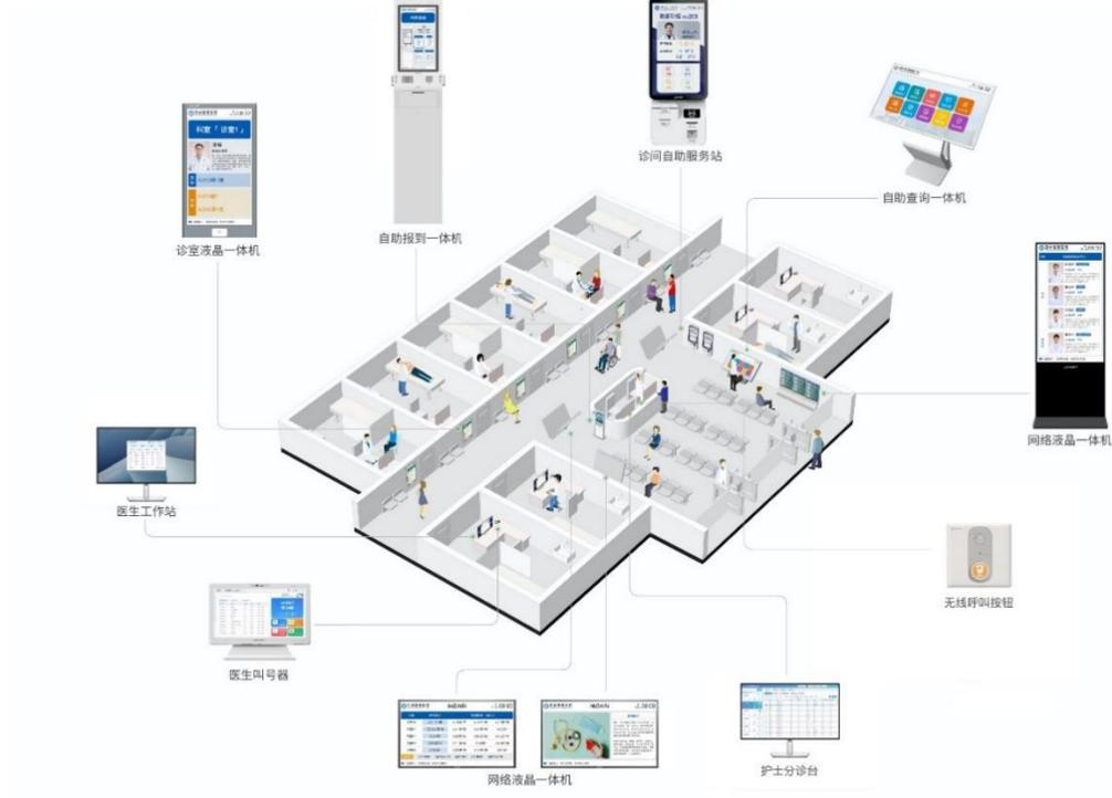
门诊服务交互系统基于分诊队列排序与智能推荐算法技术，通过产品自主研发、技术创新等方式，实现智能分诊、智能导诊、智能问诊、刷脸支付、信息服务等非诊疗功能，为患者提供诊前、诊中、诊后的全流程就医服务。同时为医院管理者提供专家排班、信息推送、电子陪护证、就诊数据统计等管理功能，推进医院运营的精细化管理。门诊服务交互系统的软件业务架构如下图所示：
