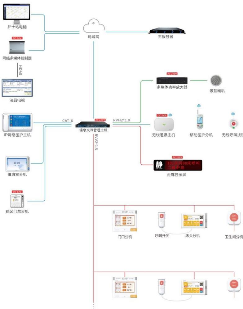
二代病房交互系统应用微服务架构软件设计，各服务独立运行，各项功能互相合作且互不影响，提升了系统的稳定性。二代病房交互系统采用 C/S 及 B/S 双体系架构作为系统开发基础，运用公司自主研发的组件化医护通讯控制台技术等核心技术，使之能够与 HIS 系统无缝对接，从 HIS 系统中调取患者相关信息，通过信息与设备的结合，优化临床业务流程，对加强病房管理、减轻医护工作强度具有重要意义。二代病房交互系统的软件业务架构如下图所示：
