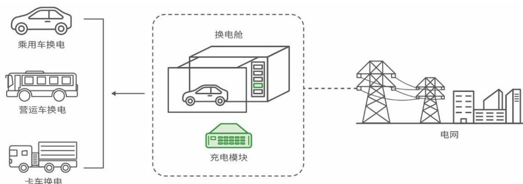
实现新能源汽车换电主要涉及换电站、车载换电系统和信息交互平台。三大系统中，换电站是动力电池的转运中心，承担动力电池集中存储、充电和状态监控等一系列功能，通常配有换电、充电、配电、温控、视觉识别、监控和消防等设备。其中，充电设备的作用是将亏电电池进行充电，以备循环使用，主要包括充电柜、充电架、充电箱等直流充电设备。
