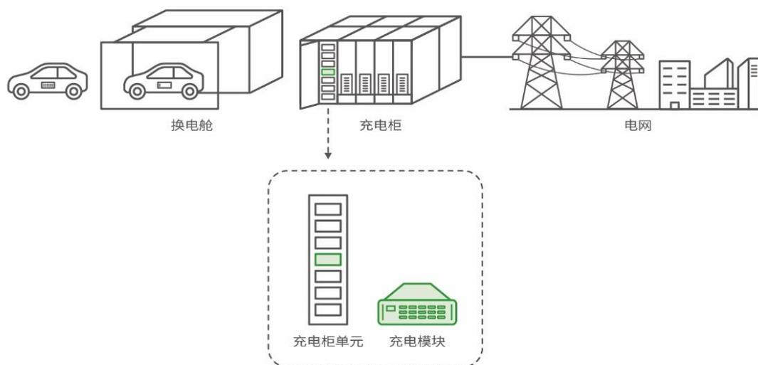
直流充电桩、充电柜等新能源汽车直流充电设备中最为重要的部件是充电模块，被誉为直流充电设备的“心脏”。充电模块对电能起到控制、转换的作用，其性能不仅直接影响直流充电设备的整体性能，同样也关联着充电安全等问题。
