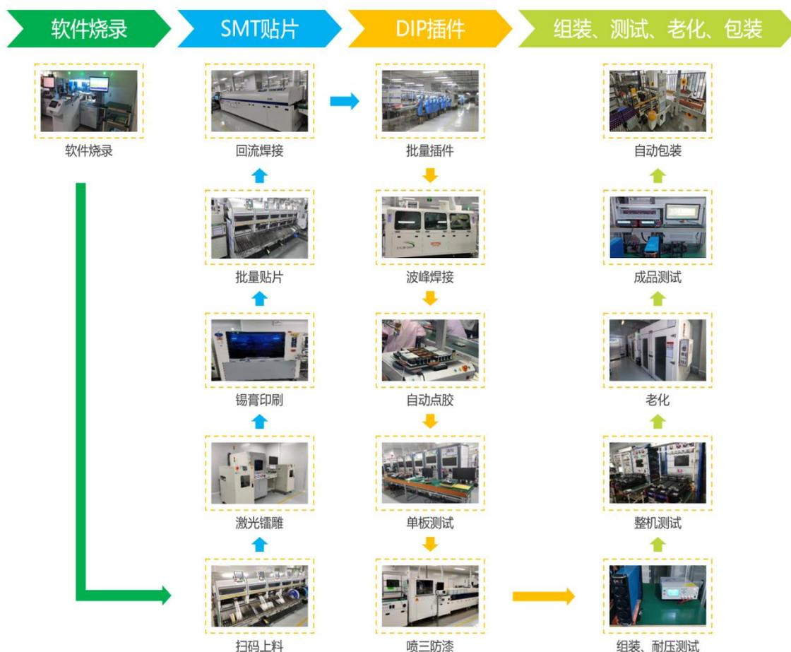
上述充电模块生产的工艺流程中，测试和老化环节运用了公司核心技术中的产品测试和老化技术，具体包括集成式自动化测试平台技术、充电模块老化系统技术。通过上述核心技术的运用，公司构建了稳定、高效的测试和老化平台，为测试和老化工序提供了硬件和软件基础。
