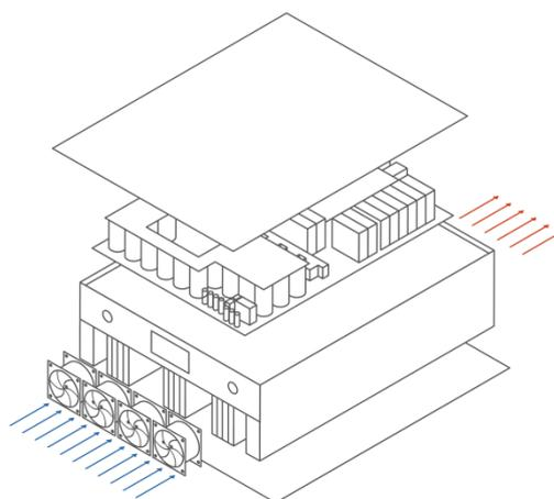
风冷散热模式采用高转速风扇强力排风，再加上充电桩的散热风扇，会产生较大噪音。为降低噪音，提高产品防护性，行业内发展出液冷散热模式。与风冷充电模块相比，液冷充电模块系统内部的发热器件通过冷却液与散热器进行热交换，噪音更低。同时，液冷充电模块采用全封闭设计，与灰尘、易燃易爆气体等杂质杂物无接触，具有更高防护性，进而提升使用效率和使用寿命。液冷散热模式相比风冷散热模式具有低噪音、高防护性的优点，但目前成本较高，适用于对噪音和防护性要求较高的场景。未来，随着技术进一步发展，液冷散热模式有望成为风冷散热模式的重要补充。
