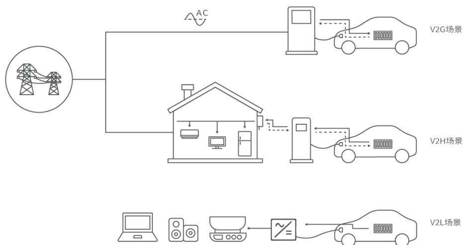
在 V2G 领域，公司开发了单相 7KW V2G 模组，并着力研制三相 11KW V2G 模组，上述产品很好地满足了在多种场景下，不同新能源汽车车型与电网双向互动的需求。该储备产品成功申请并取得了“一种锁相条件下电网参数的计算方法和可读存储介质”（专利号：ZL201911239586.6）、“一种基于三角函数特性的电网参数检测方法和可读存储介质”（专利号：ZL201911239900.0）、“一种宽电
