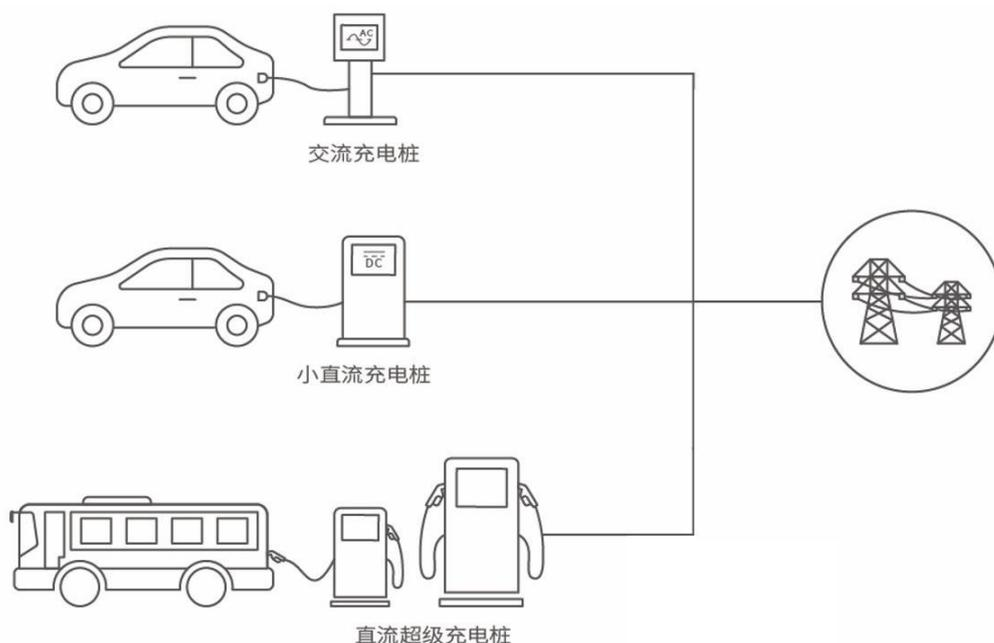
一个完整的直流充电桩主要包括充电系统、监控系统、计量计费系统等，其输入端与交流电网直接连接，输出端装有充电插头用于为新能源汽车充电。随着新能源汽车的快速发展，直流充电设备作为新能源汽车基础设施建设的重要组成部分，越来越受到包括中国大陆在内的多个国家和地区的重视，市场规模预计将实现快速增长。
