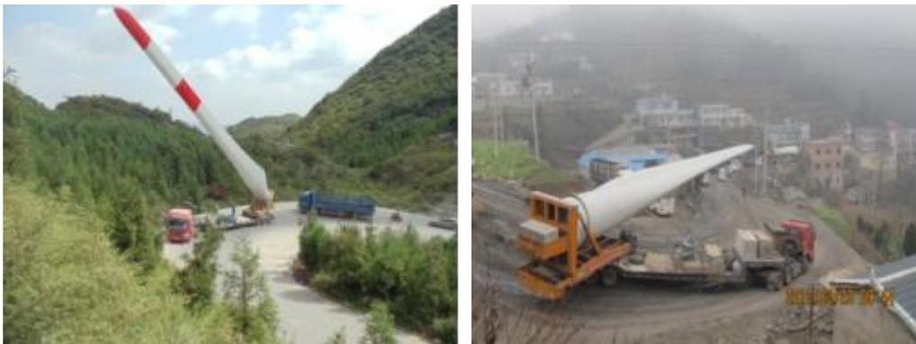
图 9.3-1 特种运输车辆运输叶片实景
