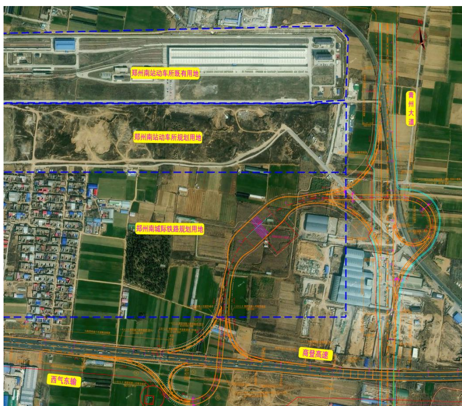
图 5-4 互通方案二平面图
