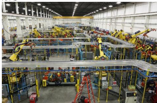
图 3. 结构件焊装自动化生产线
