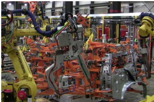
图 2. 车身焊装自动化生线
