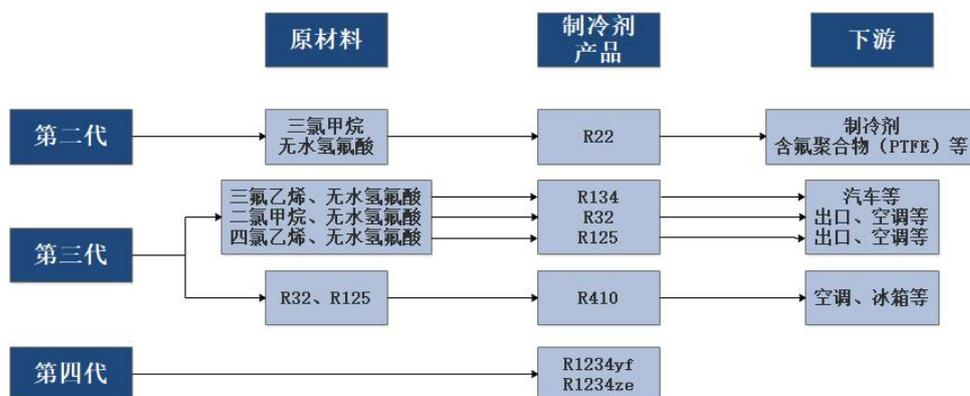
制冷剂历经四代技术迭代：第一代氯氟烃类（CFCs）以 R11、R12 为代表，臭氧破坏潜值（ODP）高。第二代氢氯氟烃（HCFCs）以 R22 为代表，ODP 值较低但仍破坏臭氧层。第三代氢氟烃类（HFCs）主流产品包括 R32、R134a，其 ODP 为 0 但全球变暖潜值（GWP）高。第四代氢氟烯烃（HFOs）类，如 R1234ze，ODP 和 GWP 均极低，环保优势显
