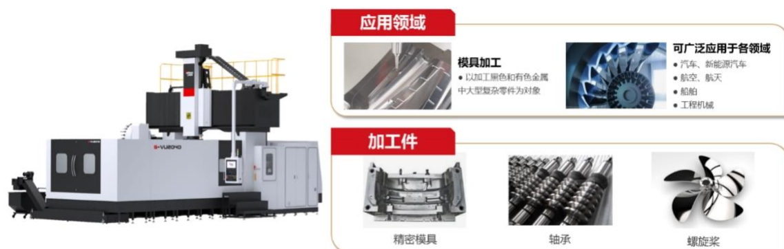
图 3-6 五轴龙门加工中心
