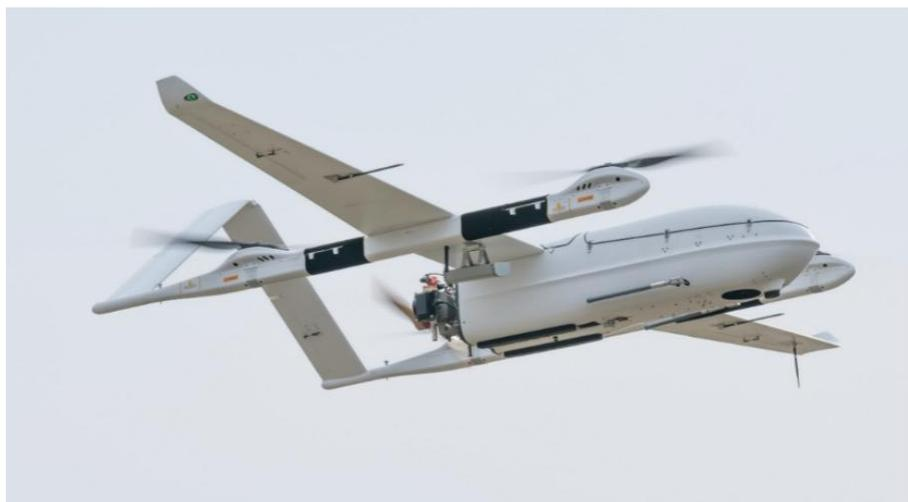
图 纵横大鹏 CW-100 垂直起降固定翼无人机
