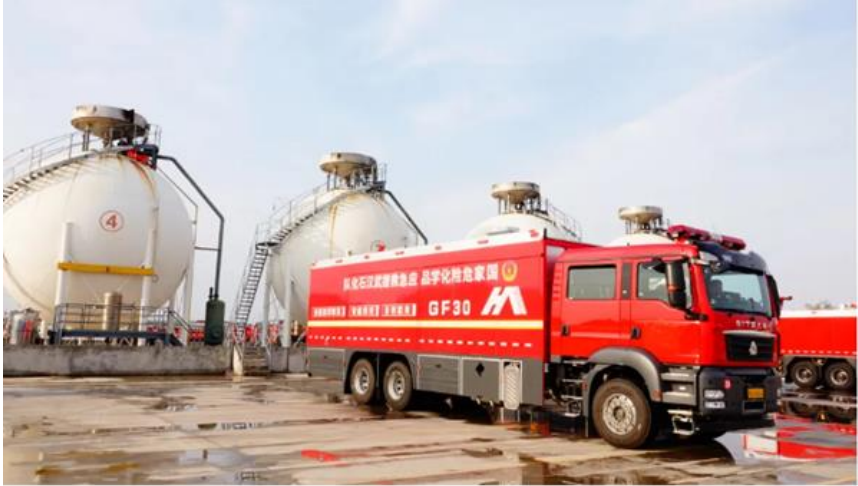
图 2 制氮气体车在球形罐区演习现场
