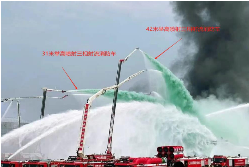
图 1 两台三相射流消防车喷射出包裹绿色超细干粉的复合射流灭火剂直击燃烧油罐表面
