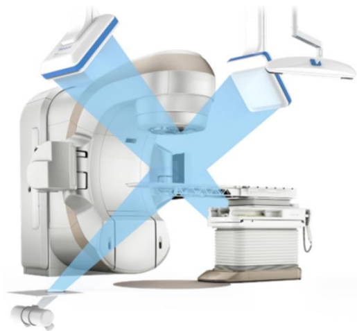
图示：立体定向放射外科机器人
