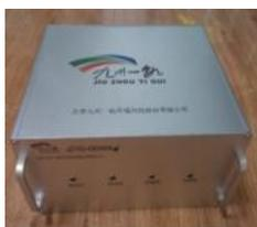
智能数据一体机可集声纹信号采集、处理、传输及存储于一体，通过 24 位高精度、可支持 51.2kHz 采样的多通道采集设备采集感知信号，通过内嵌边缘端算法实现数据实时处理，通过 4G/5G 网络或内网进行数据的实时传输，噪声振动测量事件误报率低于 0.01%，极大地提升了监测效率和质量。
