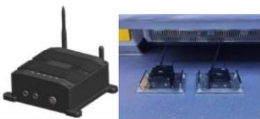
车载轨道声纹检测仪（自定位线路检查仪）是轨道动态不平顺病害检测设备，检测分析内容包括：车体振动加速度局部超限分析与晃车原因诊断、车辆运行平稳性分析、车厢内噪声检测分析与极值噪声原因诊断、车厢内噪声与振动数据综合分析。
