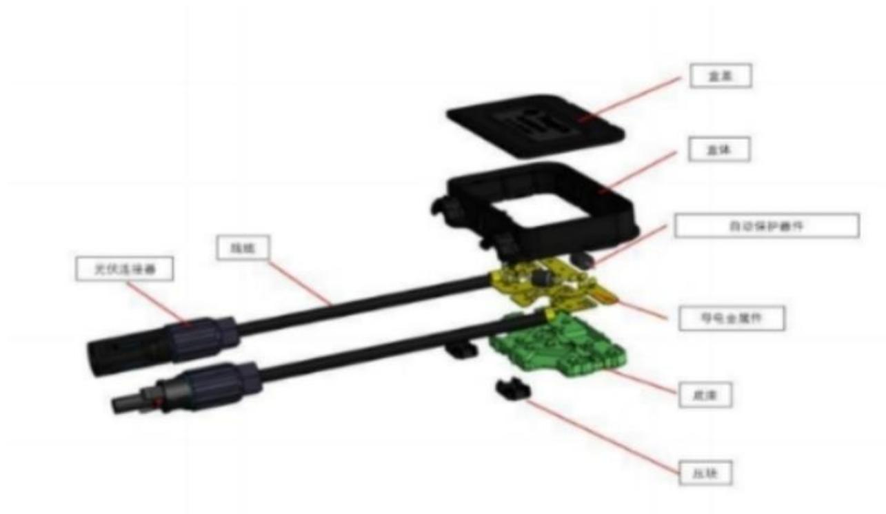
其中：①盒体、盒盖、底座等选用高分子材料通过注塑工艺生产制作而成，具备抗紫外线、耐热阻燃、抗老化等性能；②导体采用高散热性、高导电性的金属材料通过冲压工艺生产制作而成，具备良好的散热性能和优异的导电性能；③自动保护器件具备在光伏组件发生热斑效应时起到自动保护功能，所谓热斑效应指在太阳能组件的构造中，单个电池片被串联在一起，若其中一个电池片被遮挡，受影响的电池将不再作为电源工作，而是变为能量消耗者，其他未遮挡的电池板将继续通过它们传递电
