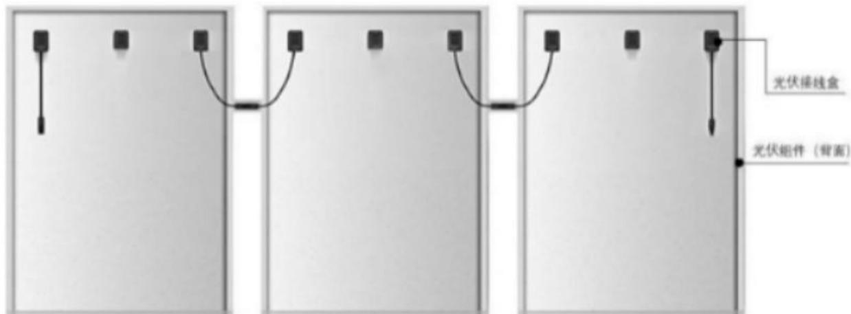
光伏接线盒产品主要由盒体、盒盖、自动保护器件、导体、底座、连接器、电缆线等配件构成。光伏接线盒结构图如下所示：
