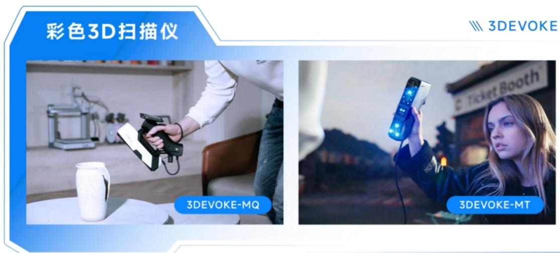
2025年3月，公司正式推出3DeVOK MQ专业级彩色三维扫描仪。这款设备以专业级性能赋能创意生产，让3D创作更加触手可及。MQ扫描仪采用22线红外激光与双幅面红外散斑双光源技术，支持无线自由扫描，摆脱了繁琐线缆的束缚。设备易用性较高，能够帮助用户高效获取数据。
