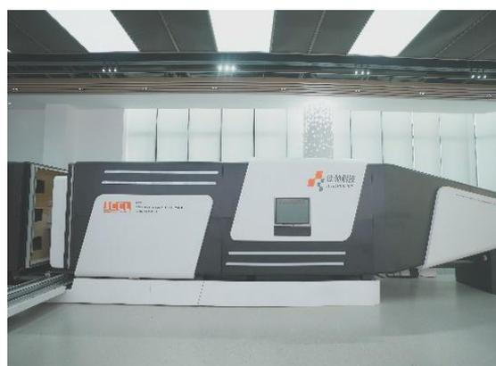
图 2 低频同轴反射率测试系统
