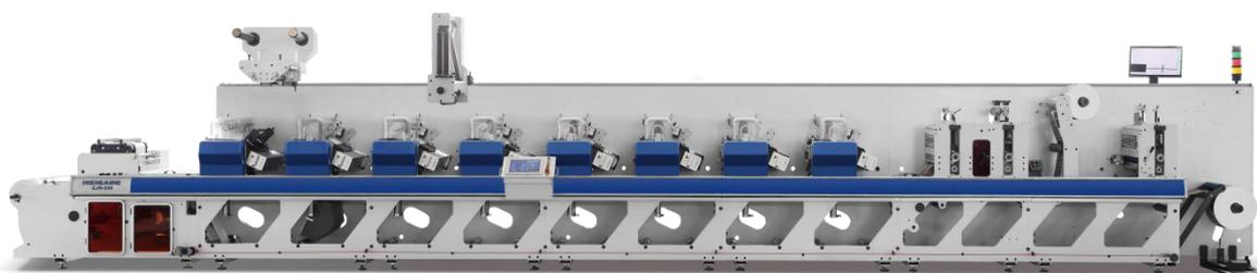
机组式柔性版印刷机最高印刷速度为 180 米/分钟，与间歇式 PS 版商标印刷机（胶印）相比，由于其速度更快、制版成本较高，更适用于大批量的印刷。整机控制系统采用微机伺服控制，每一机组单元均由独立伺服电机驱动，为机器高速运转中的高精度套准提供了保障。同时，机组式柔性版印刷机可以提供更多的色组与选配装置，实现更加多样化的印刷需求。
