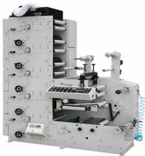
层叠式柔性版印刷机采用陶瓷网纹辊传墨，陶瓷层化学稳定性好，辊面耐腐蚀性佳，使用寿命长；网穴呈蜂巢状排布，吸墨性好，印刷效果好，可以进行高网线印刷，图案色调再现性好。该产品可根据需求添加选配模切工位、红外烘干装置等，能够实现从放卷、印刷、上光、自动红外烘干、覆膜、模切、收卷等工序的一次完成。
