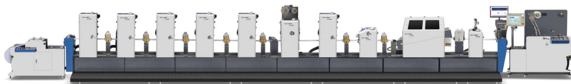
间歇式 PS 版商标印刷机（胶印）采用高品质重型胶印印刷单元，每个印刷单元由 20 根墨辊以及 4 根水辊组成，具有良好的传墨系统，能有效防止墨杠及鬼影现象的产生。同时，每一机组单元均由独立伺服电机驱动，各印刷单元调节横向和纵向移动均由独立电机控制，为机器在高速运转中的高精度套准提供了保证。该机型可以在不停机的情况下，在主控台上调节印刷品的横向和纵向套准，有效地提高了印刷品的质量和产能。
