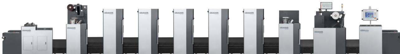
组合式高速全轮转（套筒）胶印机是公司在间歇式 PS 版商标印刷机（胶印）的技术储备基础之上，结合标签印刷市场发展趋势研制而成的最新产品。该产品创新性地研发出了可变量套筒式印刷滚筒，印刷图案长度与印版滚筒表面周长接近相等，可实现全轮转连续式印刷，解决了传统胶印机滚筒只能进行间歇式印刷的痛点，大幅提高了印刷速度，将最高印刷速度提高至 180 米/分钟。版滚筒和转印滚筒采用气胀套筒式，两个滚筒可根据印刷图案长度同时更换，适应不同长度尺寸图案的印刷，换版速度快，简单易操作，印刷效率
