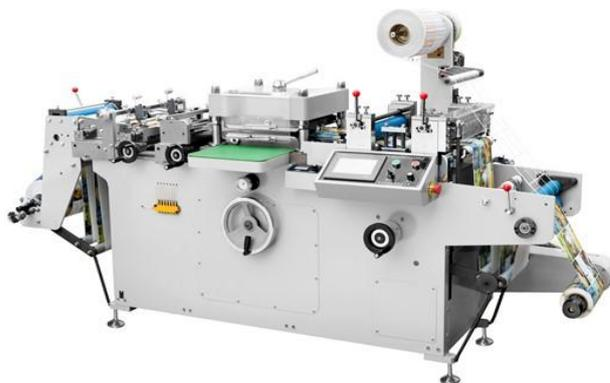
自动不干胶商标模切机能够进行平压平高精度模切，拖料及切片由电脑控制，印刷标两边及纵向由三只光电眼精确跟踪定位，能够实现精准模切，模切、收废、切片等工序全部自动化完成，可与公司的柔印机系列、胶印机系列等设备配套使用。
