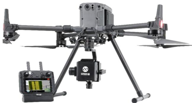
典型的无人机高光谱成像检测系统
