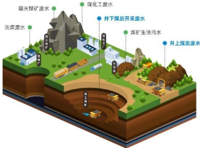
公司基于分级处理和分质利用理念，针对煤炭矿井水高浊、高盐等特点，自主研发矿井水处理与回用技术产品集群，攻克传统工艺流程冗余、占地面积大、能耗高和碳排放量大等共性难题。依托井下原位超磁分离水体净化设备、煤泥水重介质回收设备、磁沉淀快速除硬一体化设备和浓缩过滤离心机等核心设备，构建井下原位处理与回用、井下/井上深度处理与回用、井下/井上零排放处理与回用三条工艺路线，实现污染物去除与资源回收的双突破。公司已建立覆盖井下处理、地面处理、露天煤矿及应急处理等多场景的矿井水处理服务能力，通过工艺包定制、装备集群化供应及运营管理三位一体的业务架构，持续推动煤炭矿井水治理向低碳化、资源化、装备化方向升级迭代。近年来，公司已为国内40余家煤业集团提供150余项服务，代表性项目包括扎鲁特旗扎哈淖尔煤业疏干水处理项目、陕西红柳林煤矿矿井水处理项目、济宁能源高盐水资源化利用BOT项目以及陕西中太能源朱家崓煤矿矿井水零排放处理项目等。
