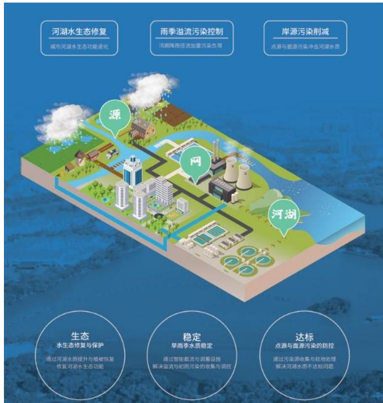
“厂网河湖整体网联”是新时期美丽河湖建设背景下，公司依托自主知识产权技术，从源头削减，过程控制，末端削减三个方面提出的系统性解决方案。针对源头污染问题，通过污染源收集与就地处理技术，解决河湖水质不达标的问题；针对汛期降雨径流造成的河湖污染问题，通过智能截流调蓄系统和集约模块化磁分离快速净化技术，完成污染物精准收集与快速削减，实现溢流与初雨污染的收集与调控；面对当前城市水生态功能退化，河湖品质不高等问题，通过整合超磁分离净化与生态修复技术，创新打造“超磁水体净化+生态韧性修复”解决方案，形成从水质提升到生态重构的技术闭环。目前，公司已形成“诊断-治理-运维”全生命周期服务，持续推动美丽河湖建设。典型案例包括嘉兴南湖、九水水环境生态修复项目，茅箭区泗河初期雨水治理项目，合肥瑶海南淝河初期雨水截流调蓄项目等。
