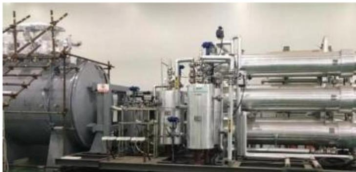
图：公司 ITER 屏蔽模块热氦检漏设备产品
