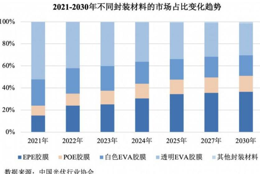
透明 EVA 胶膜具有良好的封装性能、透光率、交联度，随着光伏组件对封装要求的多元化及光伏胶膜产品的丰富与迭代，透明 EVA 胶膜的市场份额有所下降，但是在可预见的一段时间内仍是应用最为广泛的胶膜产品。白色 EVA 胶膜是透明 EVA 胶膜通过添加白色填料预处理后生产而成，其主要用于组件的背面封装，可有效提升光线反射率，使太阳能电池可利用被反射的光线进行发电，
