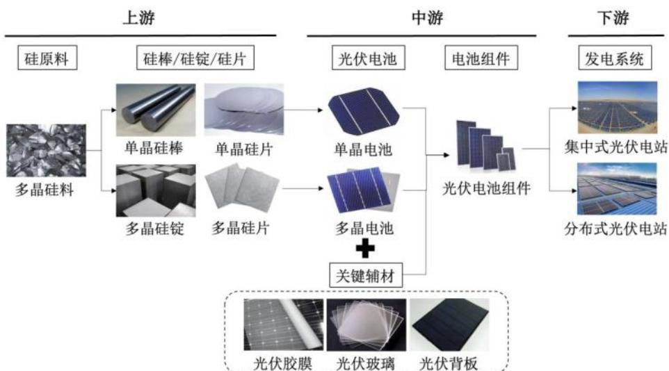
产业链中游的光伏组件是指具有封装及内部连接的、能单独提供直流电输出的、不可分割的最小太阳能电池组合装置。单体光伏电池机械强度差，容易破裂，空气中的水分和腐蚀性气体会逐渐氧化和锈蚀电极，无法承受露天工作的严酷条件，所以必须通过玻璃、胶膜、背板等辅材封装为光伏组件，才能对负载供电。
