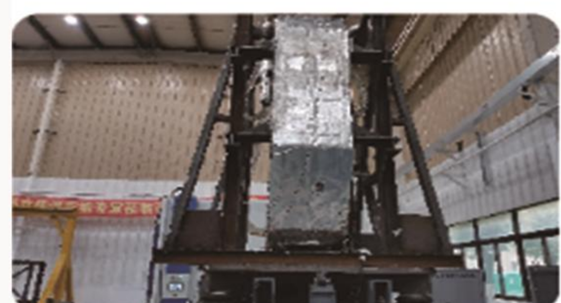
车上水箱振动冲击试验
