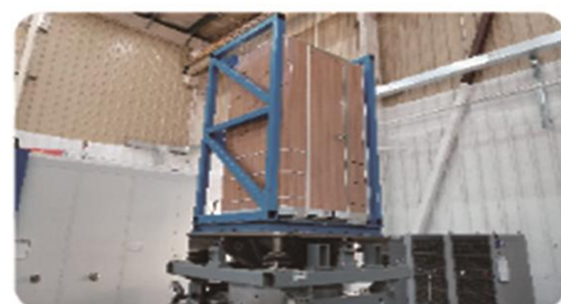
蹲式卫生间振动冲击试验
