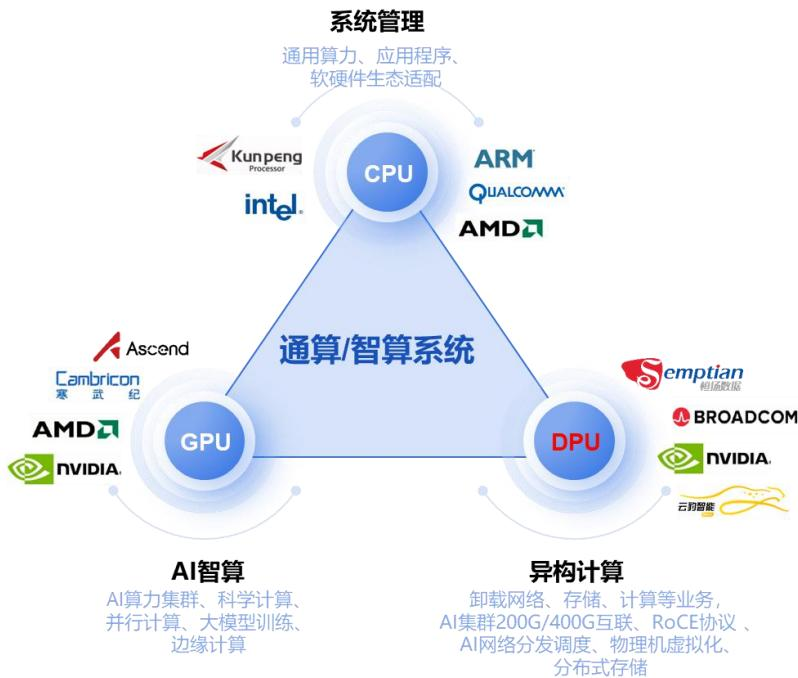
在 AI 时代，计算模式发生了根本性转变：从以 CPU（中央处理器）为核心的通用计算，转向了由 GPU/NPU 等集群驱动的规模化智能计算。可以将一个 AI 算力中心类比为一个超级物流枢纽：GPU 是数以万计的“超级分拣机器人”，负责执行核心的计算任务；CPU 是“枢纽的总指挥”，负责整体的任务调度与逻辑管理；DPU（数据处理单元）则是枢纽的“智能交通指挥系统”，部署于每个计算节点，实现所有数据的调度、传输与安全保障，确保海量数据包能够毫不停歇地、精准地送达每一个 GPU。
