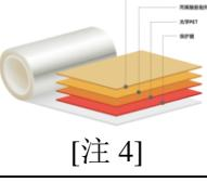
[注 4] | 柔性 OLED 屏内使用的功能膜，在模组生产中用于支撑柔性 OLED 基板，由于上层被贴合的 PI 基材及显示部分，非常薄且柔软易卷曲，支撑膜给整个模组起到了增加挺度以及保护 PI 层，避免被划伤的功能       |
