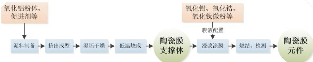
膜组件与成套设备的生产流程如下图所示：
