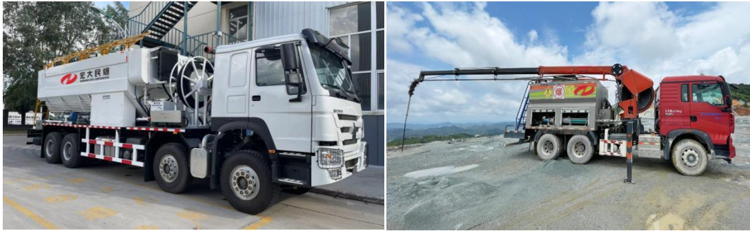
图八 现场混装炸药车
