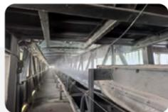
水城公司骨料输送扬尘治理项目：骨料分厂自行采购水泵、管道、接头、喷头等物资并安装水喷雾设备，在生产过程中开启设备，有效控制骨料输送系统扬尘，显著改善现场作业环境。
