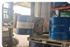
十堰危废公司人机工程抱桶器改造项目：购置抱桶器并配套叉车使用，取消人工搬运环节，降低现场作业人员劳动强度，有效防范肌肉骨骼损伤等职业病危害。
