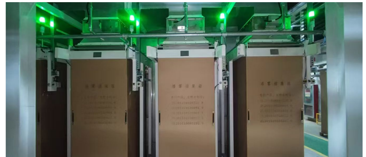
环保技术升级项目干式纸壳喷漆室的大纸箱
