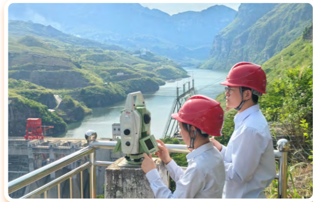
马马崖分公司水工人员开展水工建筑物监测工作
