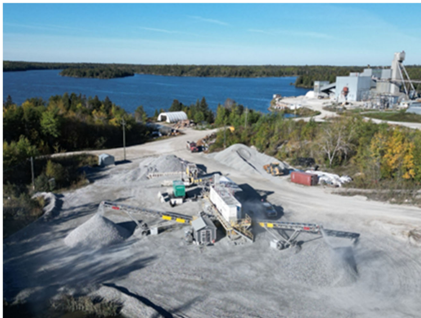
公司所属加拿大 Tanco 矿山 18 万吨/年锂辉石选厂分选区域（锂辉石）
