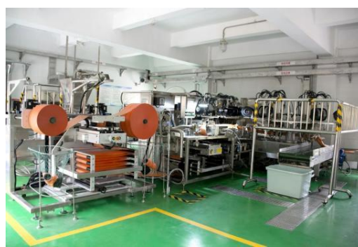
（JWL-ZW 型乳化炸药（含乳化粒状铵油炸药）智能化无人化生产工艺技术及设备）
