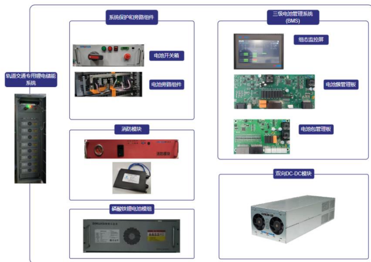
图 4：轨道交通专用锂电储能系统
