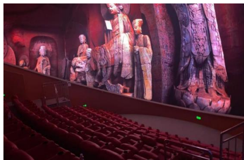
某研究院项目，内球为直径 15.6 米，点间距 1.95mm 的透声半球幕，分辨率达到 12.5K*12.5K
