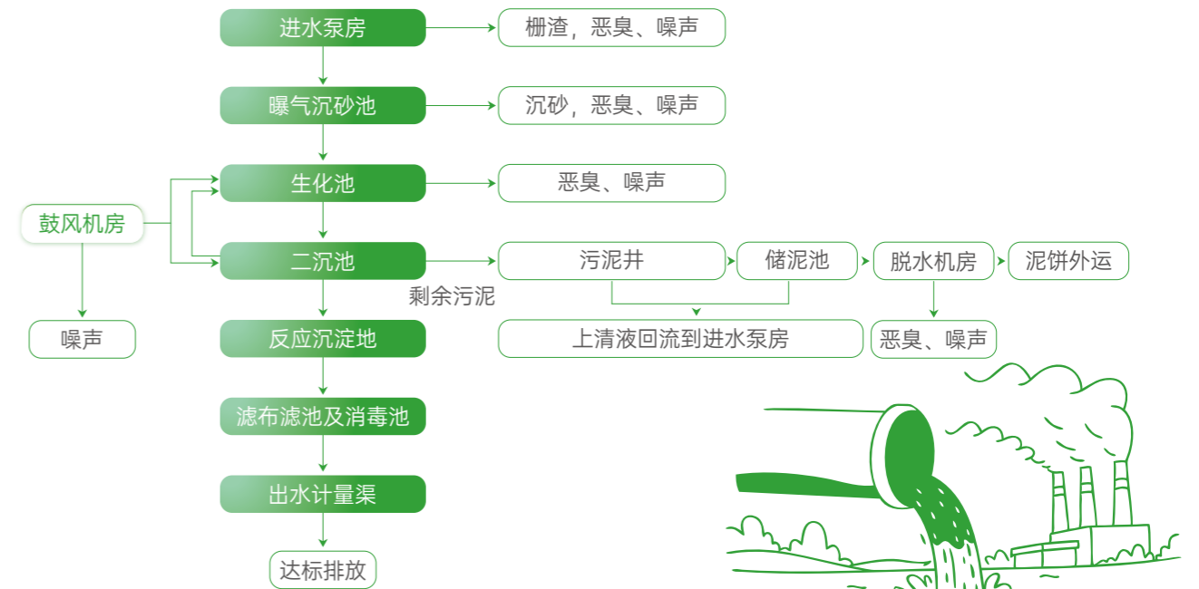
汉川瑞马生活污水处理工艺流程图
