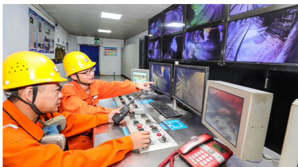
冬瓜山铜矿无人矿卡铲运协同作业远程控制室
