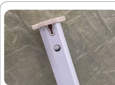
改善前:打胶孔设计,需使用胶水粘合
