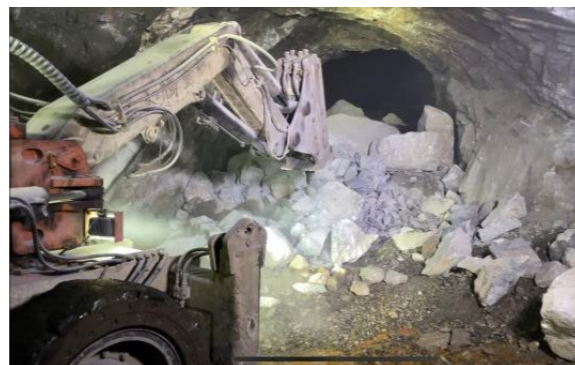
铜坑矿业遥控破碎机在井下工作
