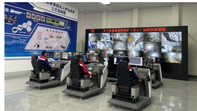
职工通过井下多装备协同采矿(无人)远程控制系统进行凿岩、铲运等工作
