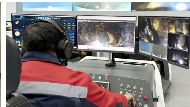
职工通过井下多装备协同采矿(无人)远程控制系统进行凿岩、铲运等工作
