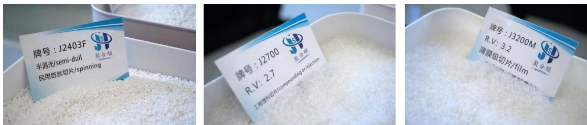
图片为尼龙 6（民用纺丝级切片、工程塑料切片、薄膜级切片）展示图
